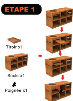
Insérez le tiroir dans le socle et installez la poignée sur le volet de la bouche d'aération.
