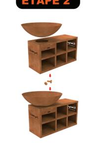
Positionnez le bol sur le socle et attachez les ensemble à l'aide de la vis et de la rondelle.
