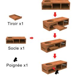
Insérez le tiroir dans le socle et installez la poignée sur le volet de la bouche d'aération.
