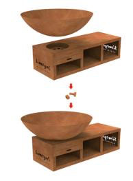
Positionnez le bol sur le socle et attachez les ensemble à l'aide de la vis et de la rondelle.
